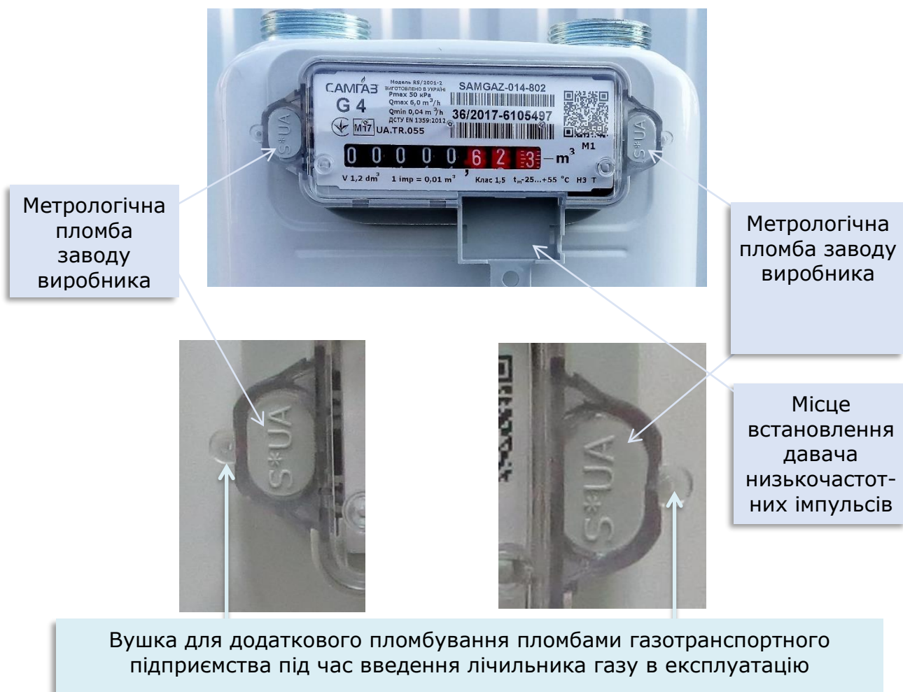
Рис. 11 Схема пломбування лічильників
